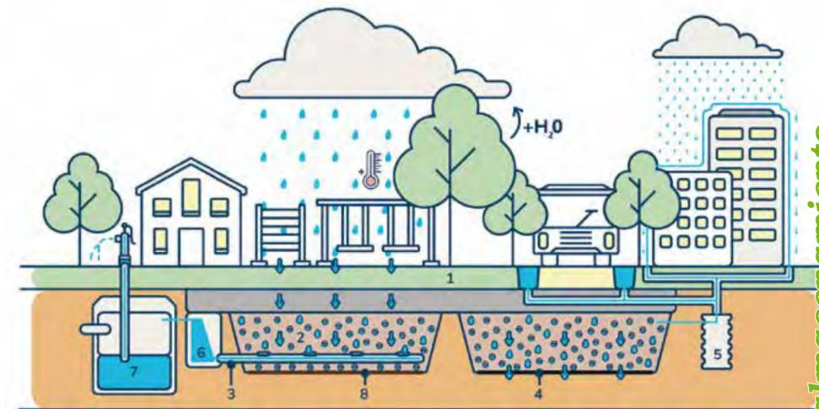
1. La superficie permeable al agua permite tanto la filtración como la evacuación del agua de la ciudad (zona circundante) y sirve para enfriar y crear un clima agradable.
